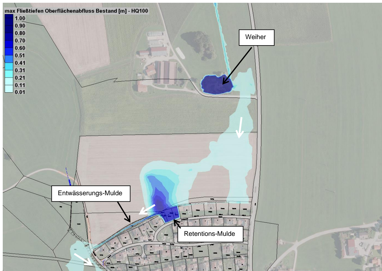
Abbildung 1.3: Beschreibung der Abflusssituation HQ 100 anhand der Ergebnisse des hydraulischen Bestandsmodells
